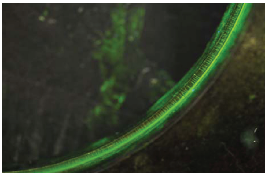
Figura 1 - Test di sensibilità eseguito con Elite FW1 su anello forgiato contenente cricche superficiali
