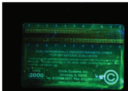
Figura 3 - Test di sensibilità eseguito su Elite FW1C utilizzando "Magnetic Strip Card"
